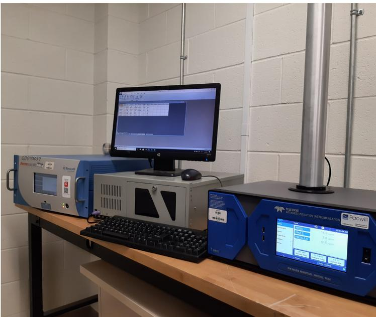
Légende : Matériel de surveillance de la qualité de l'air. Un appareil de surveillance de l'ozone (O<sub>3</sub>) (à gauche) et un appareil de surveillance des matières particulaires (PM<sub>2,5</sub>) (à droite)
